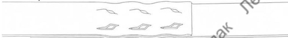
Неправильная пломба (уплотняющий механизм отрегулирован слишком высоко). Штампованные пломбы недостаточно глубока, и верхняя лента не срезана. Прочность этого уплотнителя недостаточна, и обвязку необходимо снять с упаковки. Инструмент необходимо немедленно отрегулировать (см. РЕГУЛИРОВКА УПЛОТНЕНИЯ).
